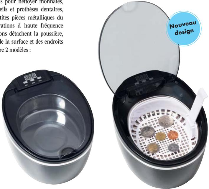
Le couvercle rabattable avec grand hublot s'ouvre en appuyant sur un bouton. Bassin intérieur en acier inoxydable, panier à mailles fines, support pour montres et CD/DVD. Ecran digital indiquant à la seconde le temps de nettoyage. Réglage de la durée du nettoyage : 90, 180, 280, 380, 480 secondes. Contenance : 600 ml. Fréquence de nettoyage : 43 kHz. 50 watts. Branchement électrique (prise Euro). Format extérieur : 220 x 175 x 130 mm.
